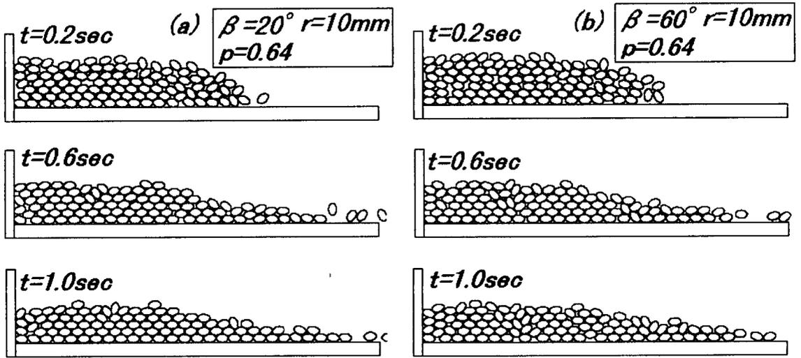
Fig. 5 Flow pattern ( $T=0.01\text{sec}$ ,  $a=0.1\text{mm}$ )
