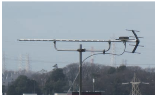
(b) An example of an actual Yagi–Uda antenna.
