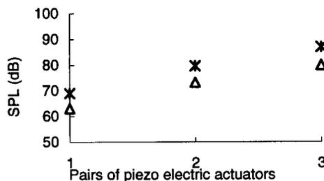
$\Delta$  1,1 mode (100 Hz)  $\times$  1,3 mode (200 Hz)
